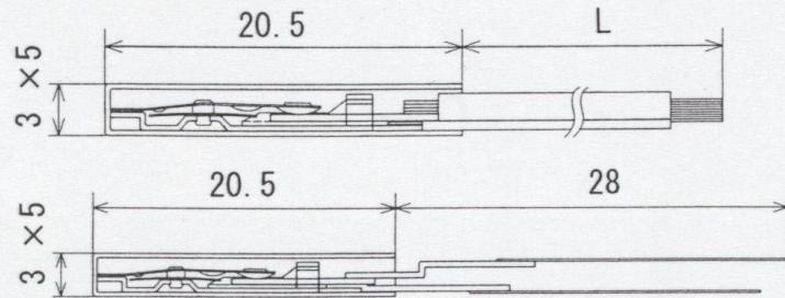
本サーモスタッフは温度、又は電流で動作する小型大電気容量のバッテリー及び直流電源用の安全器です。
